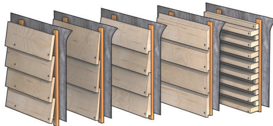
Horizontale gevelbekleding: potdekselwerk, bevel siding, Zweeds- en halfhouts rabat
