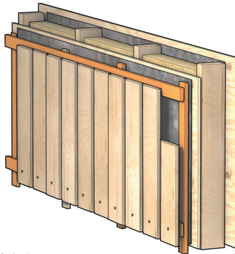
Tekening A: Een voorbeeld van een dubbel regelwerk.
